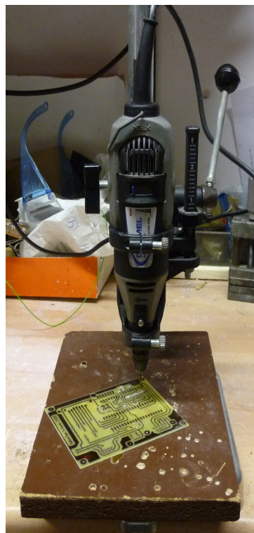
Abbildung 11: Bohren der Löcher
